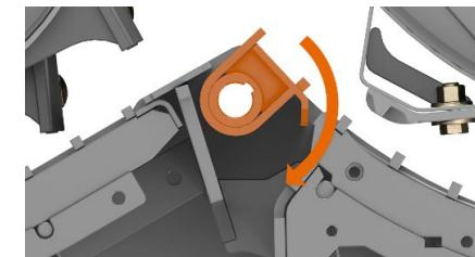
I overgangen fra forbroen til hovedbroen sidder den drejelige tærsketrolineal (orange). Den drejes ind og ud hydraulisk. Betjeningen sker ligesom tærsketroklappen med CEBIS og er integreret i CEMOS AUTO THRESHING.
