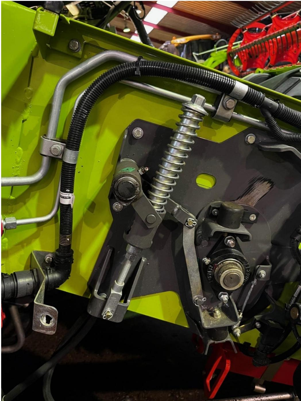
Ved en "fire cifret" Claas model kan Cruise Control indstilles på højre side af sluget. Fjederen indstilles på 17 cm i korn og 22-23 cm i frø – så kan Cruise Control selv styre hastigheden og belastningen af maskinen.
