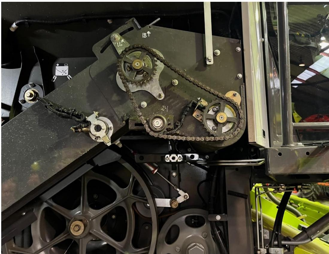
Returelevatoren kæden må ikke være for kort, da den derved får svært ved at aflevere materialet og kapaciteten falder. Så kæden skal først kortes når den ikke kan justeres længere.
